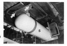
Démonter le réservoir d'eaux usées comme décrit dans le manuel.
